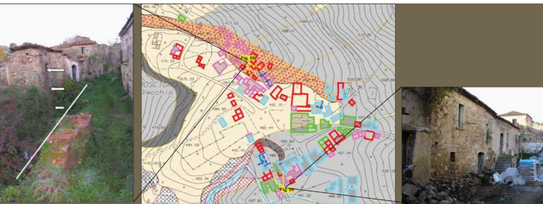
Figura 8 - Stralcio della “Carta delle frane, dei danni e delle evidenze di dissesto” nel borgo di Roscigno Vecchio. Figure 8 - Part of the Roscigno Old Village “Landslide-inventory, Damage and Instability Map”.
