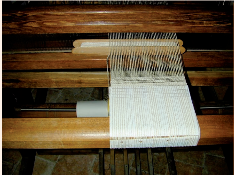
Passaggio del filo della trama attraverso l'ordito con la spoletta
